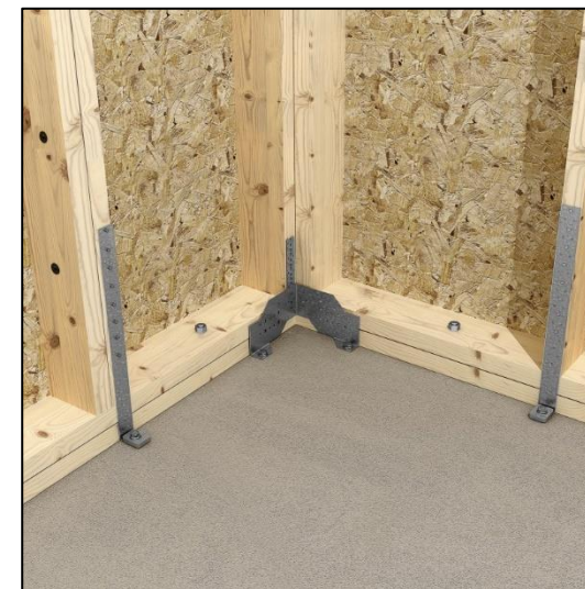
Figuur 6 Ankers die HSB constructie vastzetten
